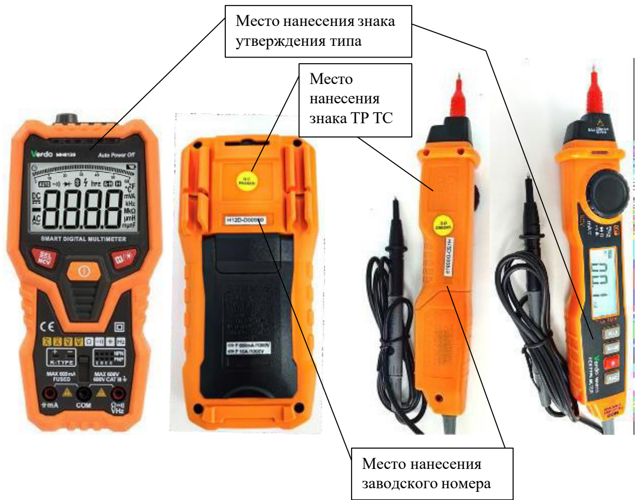
Рисунок 2 – место нанесения заводского номера, знака утверждения типа, знака TP TC на примере задней панели модификаций MB2102
