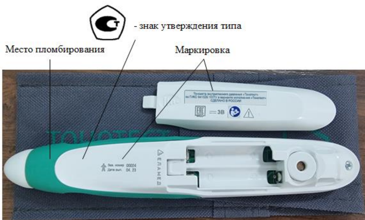
Рисунок 2 – Схема маркировки и пломбирования от несанкционированного доступа тонометров в варианте исполнения «Тонотест»
