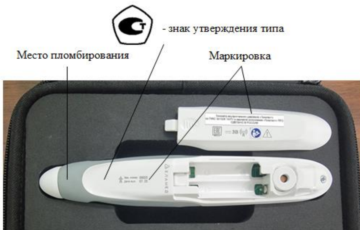
Рисунок 4 – Схема маркировки и пломбирования от несанкционированного доступа тонометров в варианте исполнения «Тонотест» ПРО
