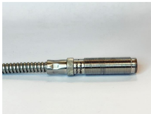
и) МЭД-1Т с кабелем в металлорукаве, с видом взрывозащиты Ex ia и общепромышленное исполнение (тип резьбы корпуса: M14-M42, 9/16'-18 UNF - 1 1/2'-12 UNF)
