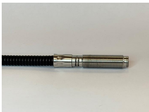
р) МЭД-1Т с кабелем в металлорукаве с ПВХ оболочкой, общепромышленное исполнение (тип резьбы корпуса: M12, 1/2'-20 UNF)
