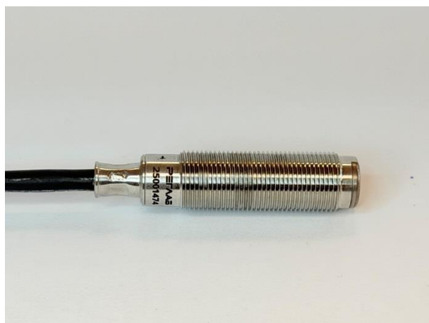
н) МЭД-1Т 1ФОК1 с кабелем без металлорукава, с видом взрывозащиты Ex ia и общепромышленное исполнение (тип резьбы корпуса: M14-M42, 9/16'-18 UNF - 1 1/2'-12 UNF)
