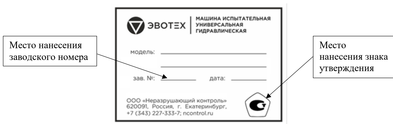
Рисунок 4 – Общий вид маркировочной таблички с обозначением места нанесения заводского номера и знака утверждения типа
