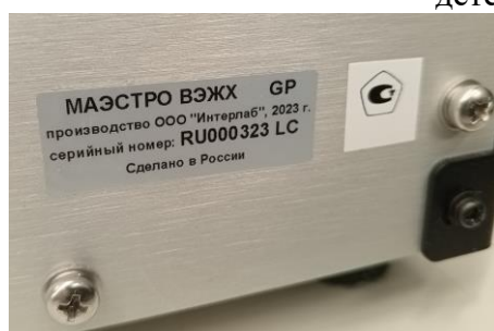
Место нанесения маркировки и знака утверждения типа на задней части корпуса блока
