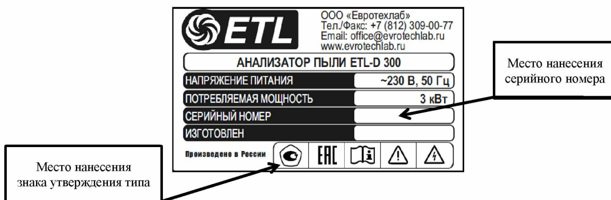
Рисунок 2 – Пример таблички измерительного блока
