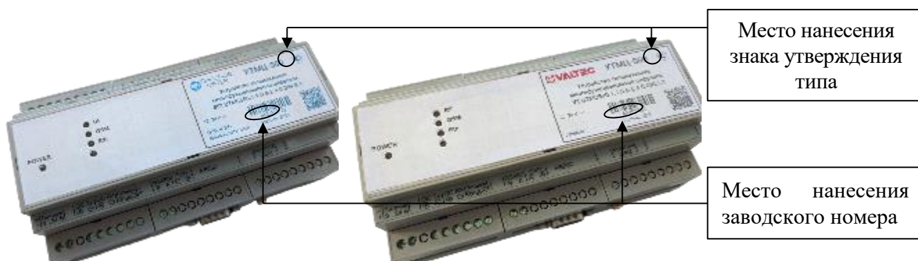
Р и с у н о к 3 – Общий вид устройств серии UTMC500 с указанием мест нанесения знака утверждения типа и заводского номера
