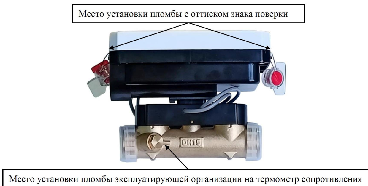
Рисунок 2 – Схема пломбировки средства измерений
