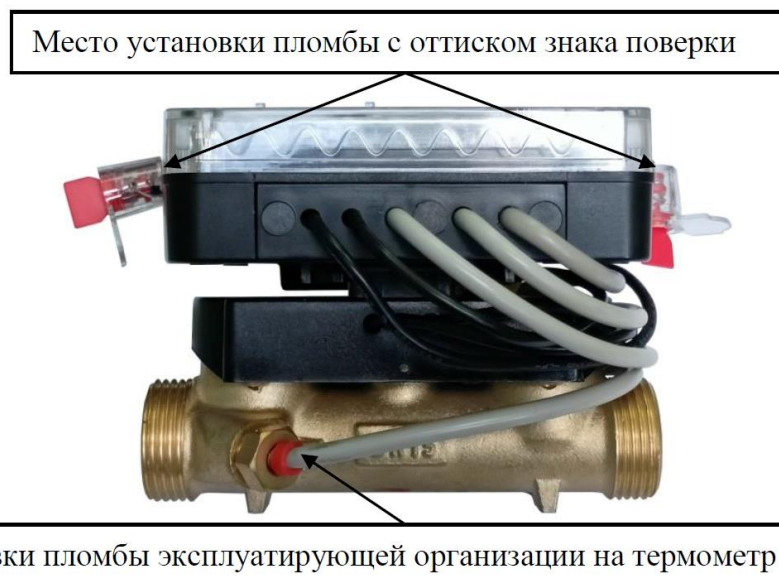
Рисунок 6 – Схема пломбировки средства измерений с модификацией электронной части 3
