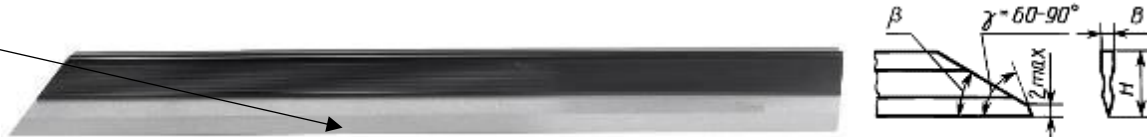
Рисунок 6 – Общий вид линейек ЛД, обозначение основных размеров поверхностей
