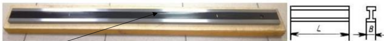
Рисунок 1 – Общий вид линейек ШД, обозначение основных размеров
