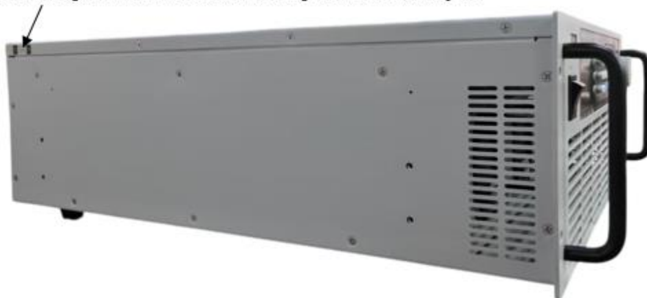
Рисунок 3 – Место пломбирования от несанкционированного доступа нагрузок FT68206A-150-600, FT68206A-600-420, FT68206E-150-600, FT68206E-600-420
