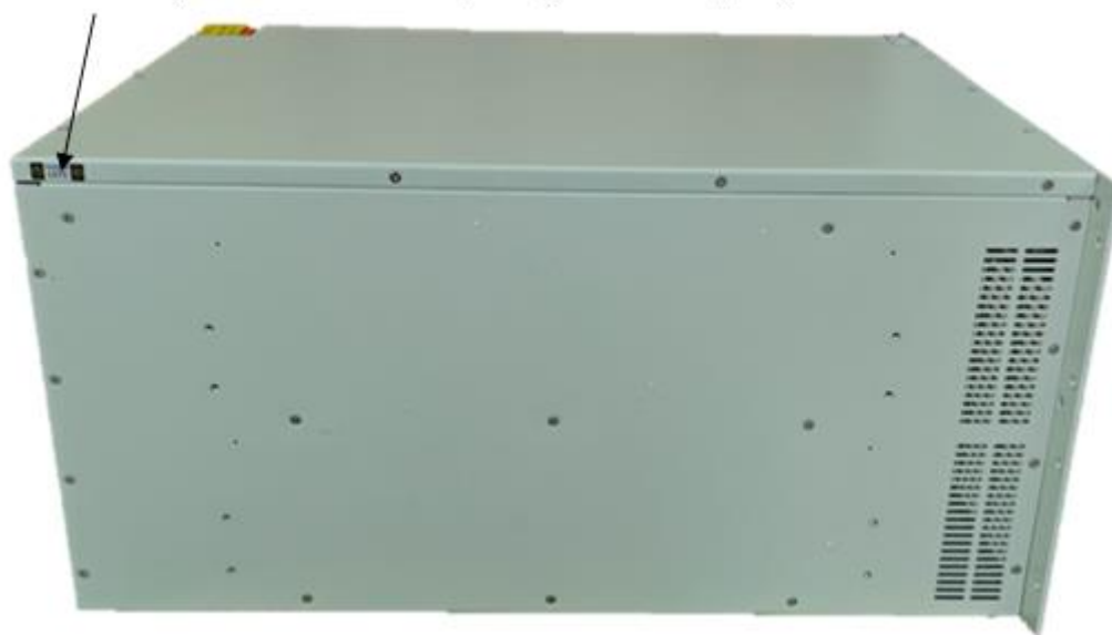
Рисунок 4 – Место пломбирования от несанкционированного доступа нагрузок FT68208A-150-800, FT68208A-600-560, FT68210A-150-1000, FT68210A-600-700, FT68212A-600-840, FT68208E-150-800, FT68208E-600-560, FT68210E-150-1000, FT68210E-600-700, FT68212E-600-840
