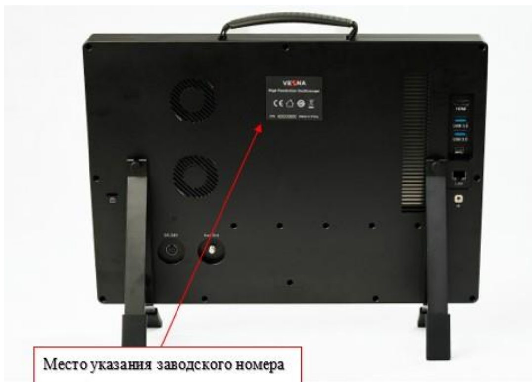
Рисунок 5 – Вид задней панели модификаций OVA3-402, OVA3-403, OVA3-405
