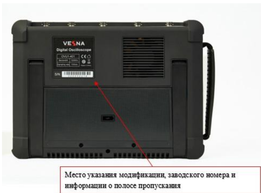
Рисунок 6 – Вид задней панели модификаций OVU1-401, OVU1-202, OVU2-402, OVU2-403
