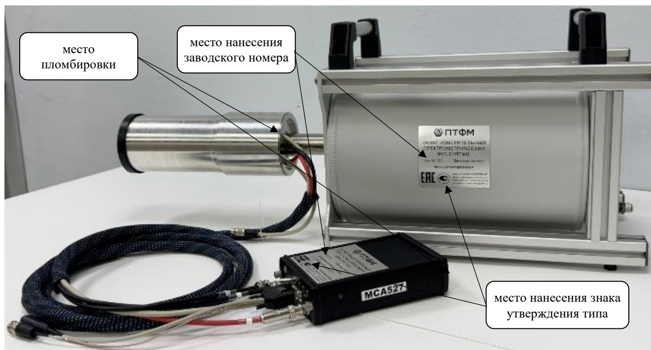
Рисунок 1 – Общий вид МКС-01ПТФМ с указанием мест пломбировки, мест нанесения знака утверждения типа, заводского номера
