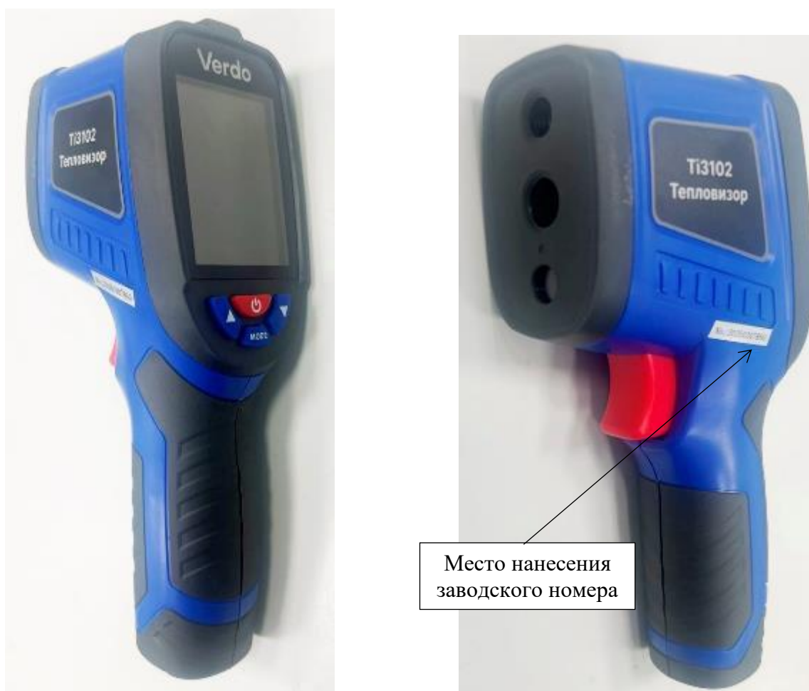
Рисунок 2 – Общий вид тепловизоров модели VERDO Ti3102
