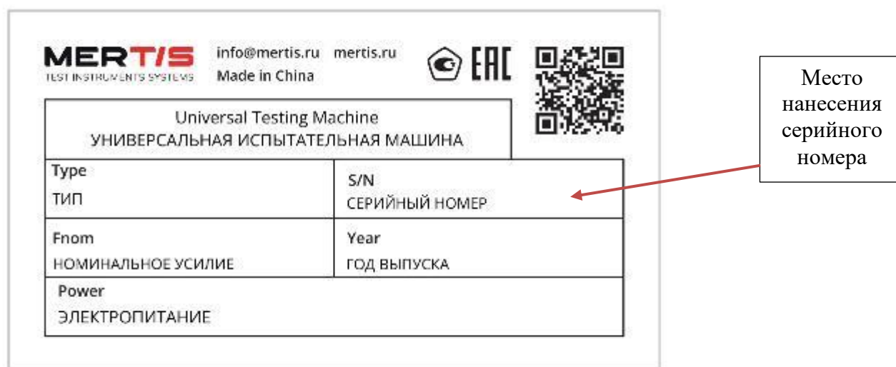
Рисунок 9 – Типовая маркировочная табличка с указанием места нанесения серийного номера
