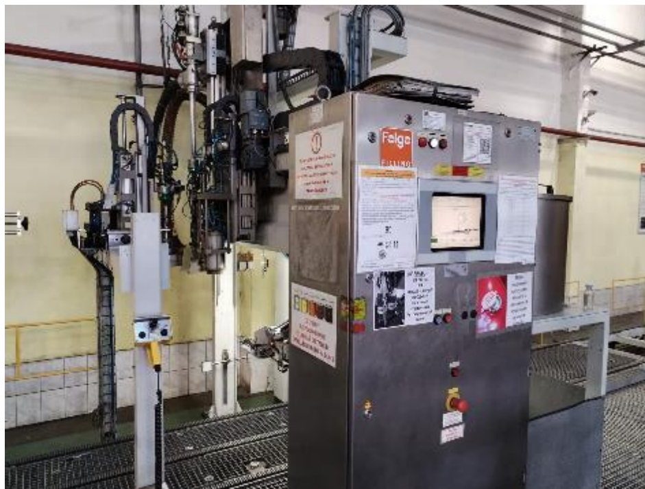
Рисунок 1 – Общий вид дозатора весового дискретного действия FS-T10K (серийный номер 091323)
