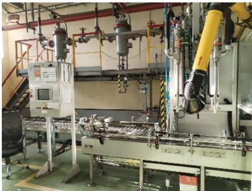
Рисунок 2 – Общий вид дозатора весового дискретного действия FS-T10K (серийный номер 095226)
