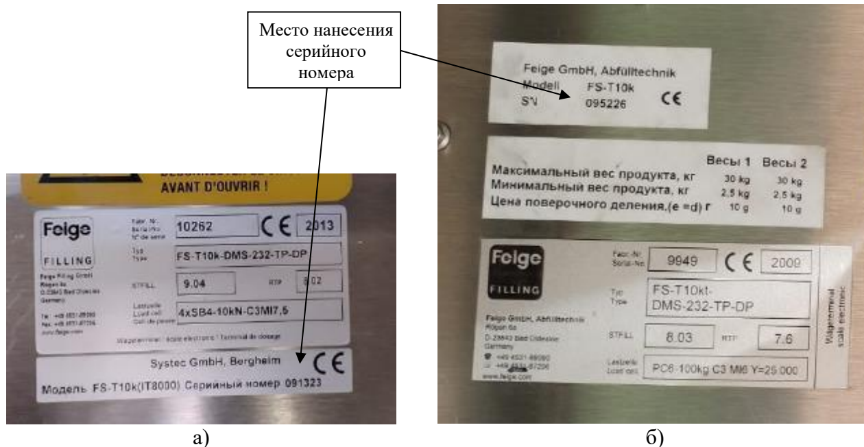
Рисунок 4 – Место нанесения серийного номера на дозаторы весовые дискретного действия FS-T10K а) серийный номер 091323, б) серийный номер 095226
