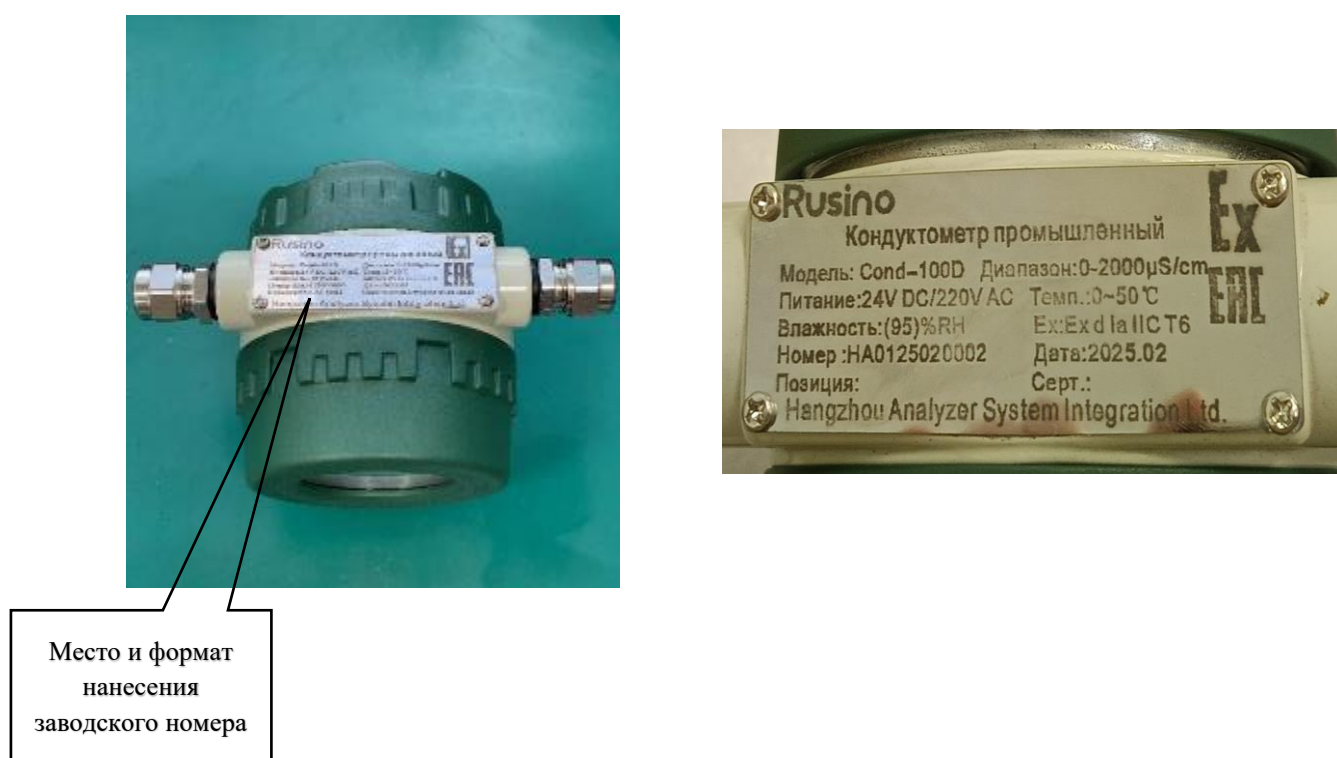
Рисунок 1б – Общий вид задней панели вторичного преобразователя кондуктометра с указанием места и формата нанесения заводского номера
