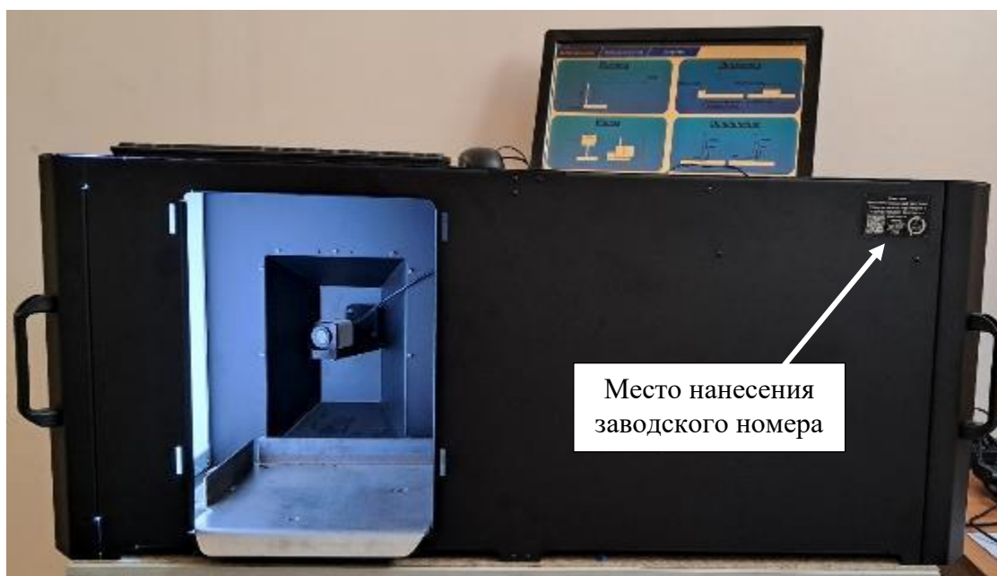
Рисунок 1 – Общий вид и место нанесения заводского номера комплексов автоматизированного контроля геометрических параметров и подбора пружин рессорного комплекта ВАРД
