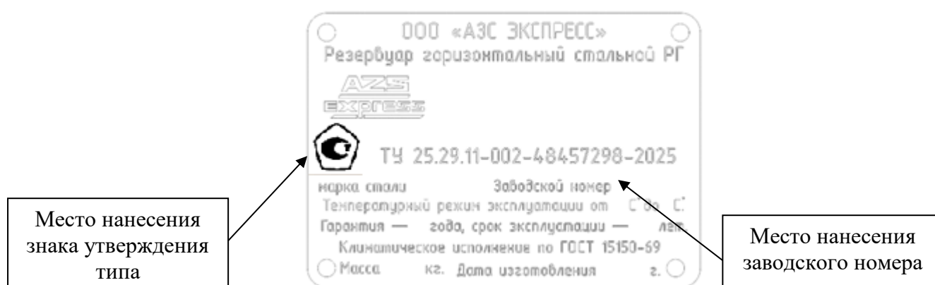
Рисунок 3 – Внешний вид маркировочной таблички, место нанесения знака утверждения типа и место нанесения заводского номера
