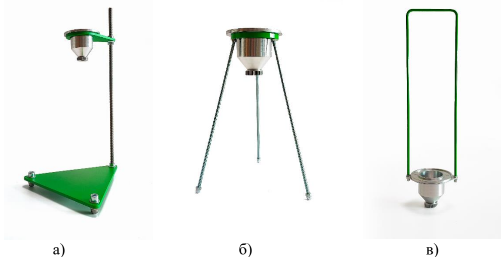
Рисунок 2 – Способы установки вискозиметров ПРОМТ а) штатив, б) опора с регулируемыми ножками, в) фиксирующее кольцо с ручкой
