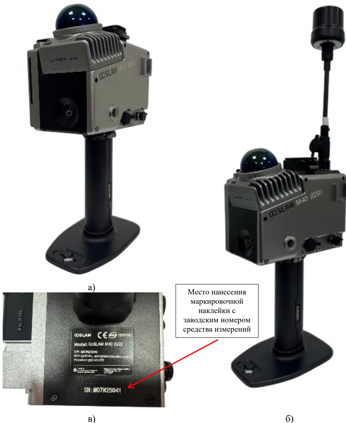
Рисунок 1 – Сканеры лазерные мобильные GOSLAM M40: а) модификация GOSLAM M40; б) модификация GOSLAM M40 RTK; в) место нанесения заводского номера
