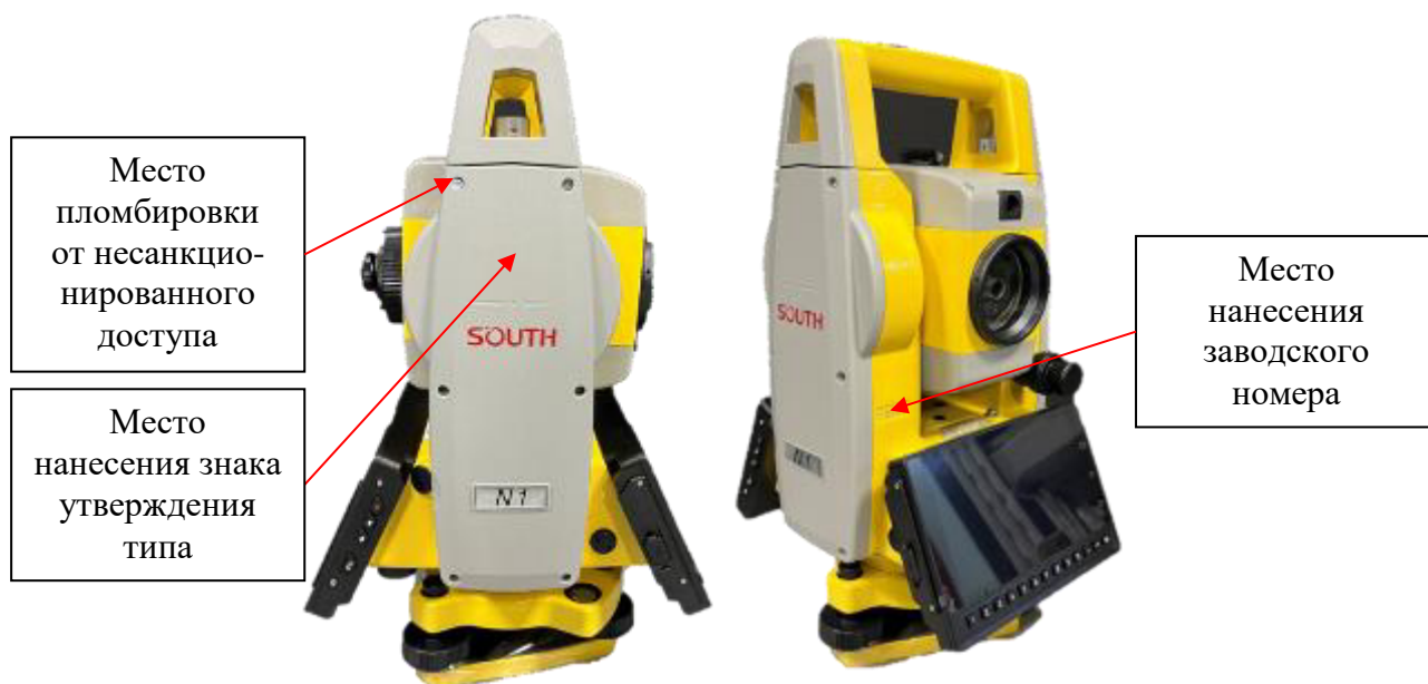
Рисунок 2 – Места нанесения знака утверждения типа и пломбировки от несанкционированного доступа
