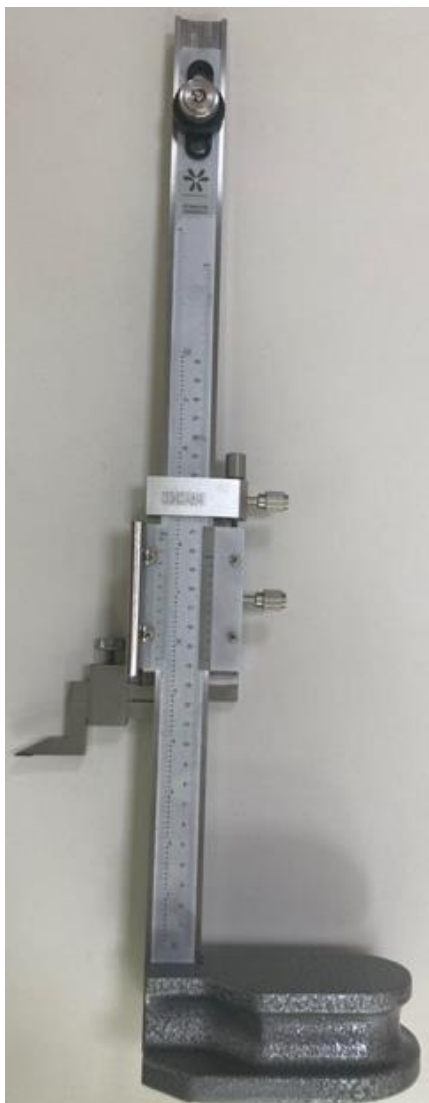
Рисунок 9 – Общий вид штангенрейсмасов модели 4131
