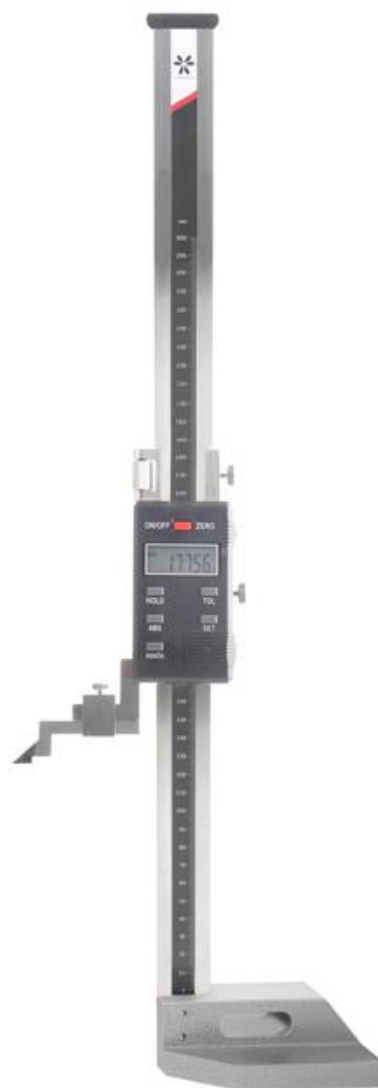
Рисунок 2 – Общий вид штангенрейсмасов модели 4111 модификаций 4111-1000, 4111-1500, 4111-2000
