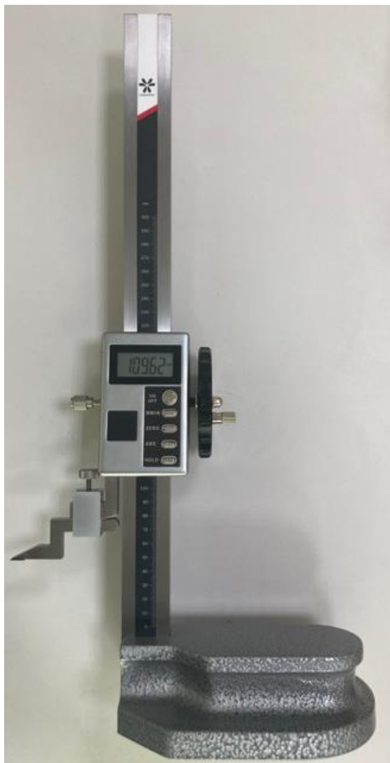
Рисунок 5 – Общий вид штангенрейсмасов модели 4113
