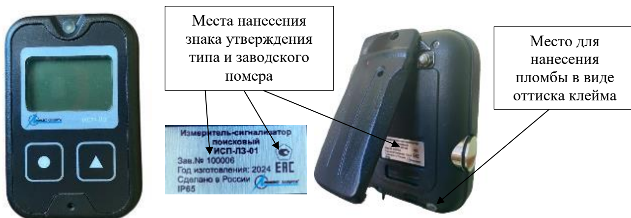
Рисунок 1 – Общий вид ИСП-ЛЗ с указанием мест пломбирования, нанесения знака утверждения типа и заводского номера
