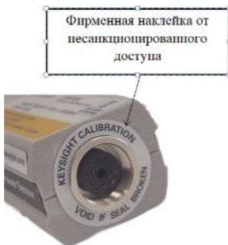
Рисунок 3 – Схема пломбировки от несанкционированного доступа
