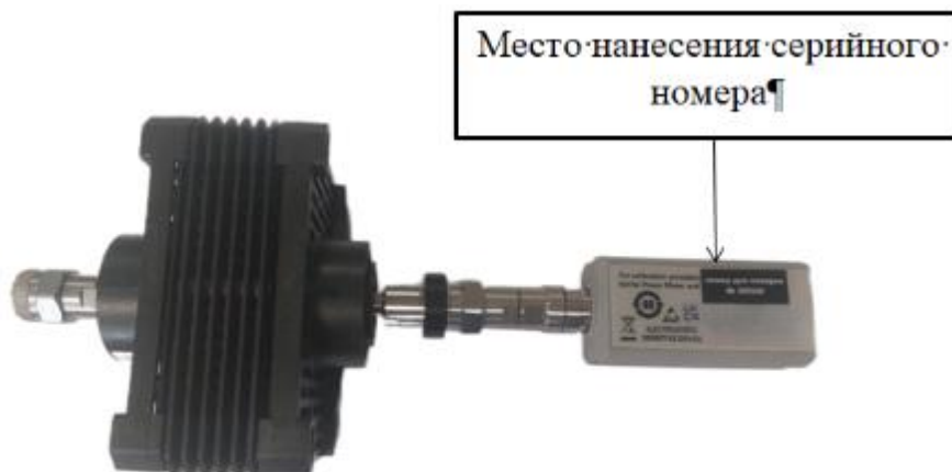
Рисунок 2 – Вид задней панели с указанием места нанесения серийного номера
