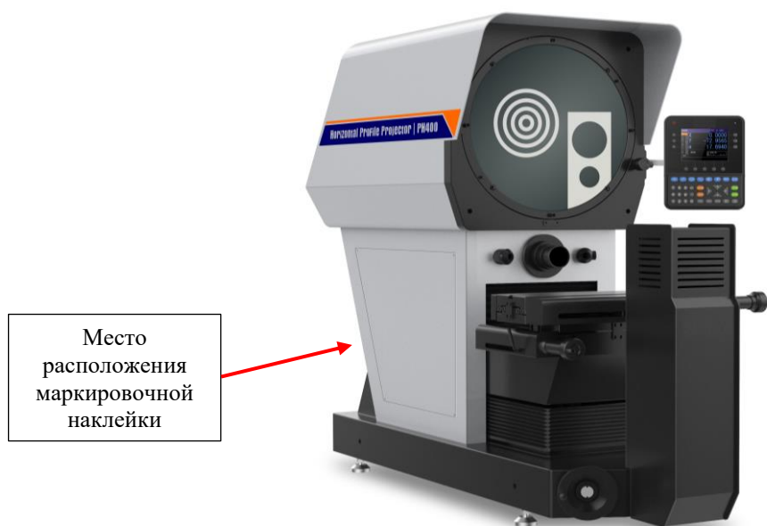
Рисунок 2 – Общий вид проекторов измерительных MICROMER модификации PH400
