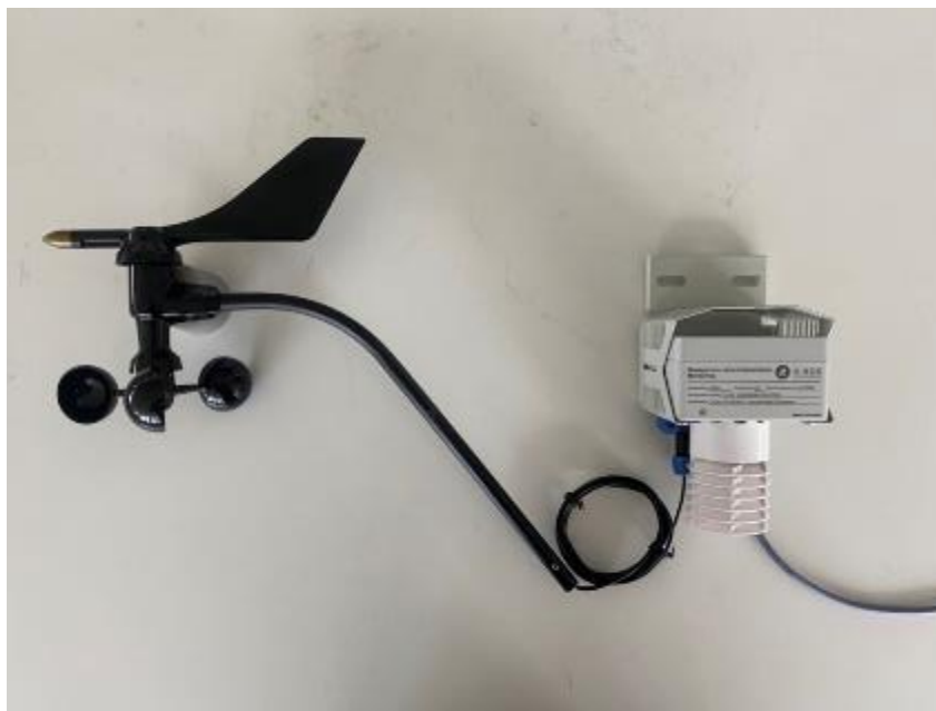
Рисунок 3 – Измеритель метеопараметров МетеоНод с модулем анемометра
