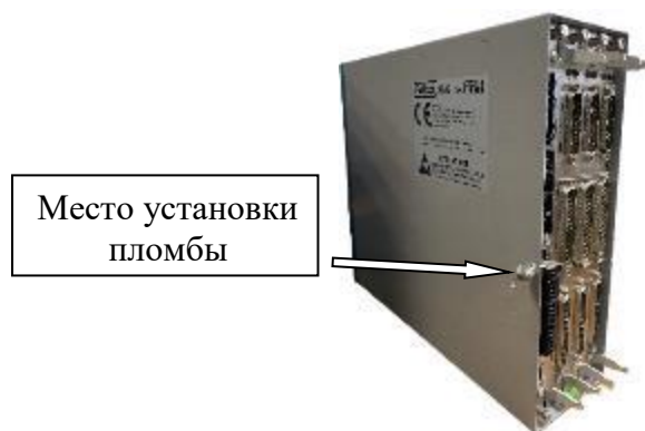
Рисунок 2 – Схема пломбировки ИВК
