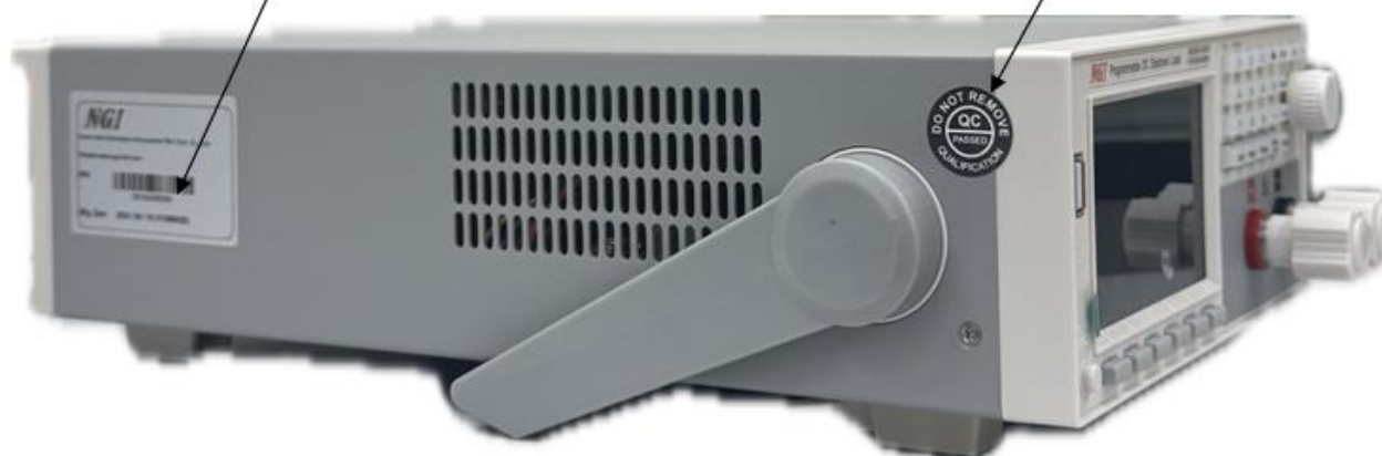
Рисунок 2 – Схема пломбировки средства измерений и место нанесения заводского номера
