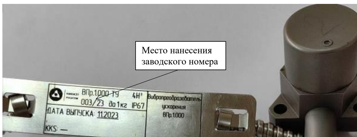
Рисунок 2 – Место нанесения заводского номера на вибропреобразователи ускорения ВПр.1.000 и ВПр.1.000-01
