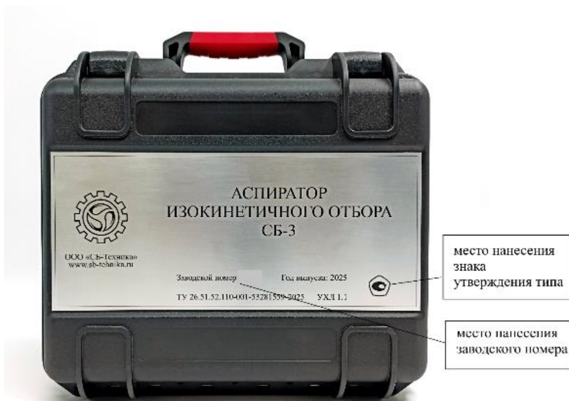
Рисунок 2 – Общий вид маркировочной таблички с указанием мест нанесения знака утверждения типа и заводского номера
