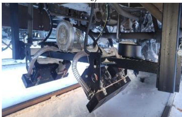
Рисунок 2 – Общий вид систем измерительных ВЗОР-И: а) и б) – подсистема видеоизмерительная ПВИ с различными цветами исполнения и с указанием места нанесения маркировочной этикетки; в) – подсистема ДБП-2
