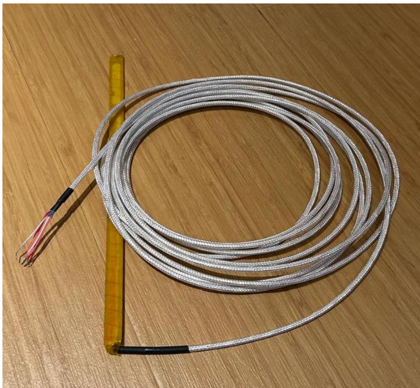
Рисунок 1 – Общий вид термопреобразователей сопротивления WZPDA2*10*250-6G
