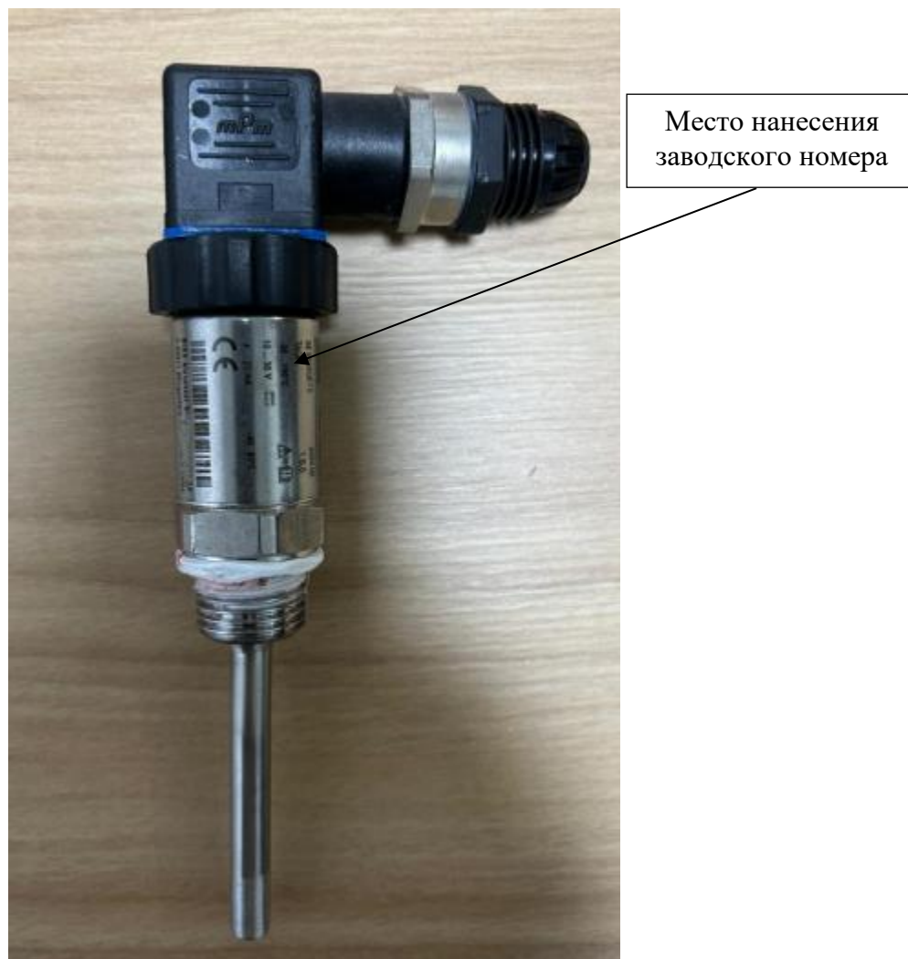
Рисунок 1 – Общий вид датчиков температуры TR36-ZZZZ-TT
