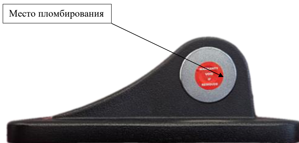
Рисунок 4 – Место пломбирования винта крепления торсионного вала измерителей крутящего момента силы AIST мод. AIST 16005115, AIST 16005120, AIST 16005130 и AIST 16005140
