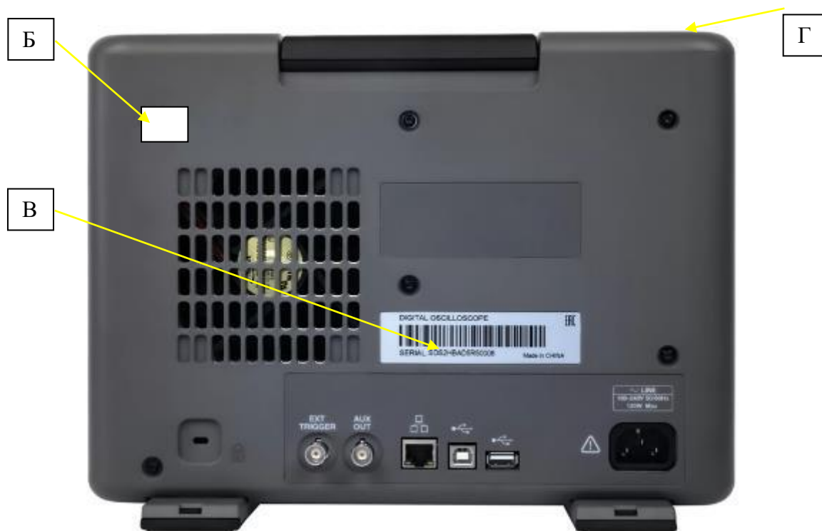
Рисунок 2 – Вид сзади, место пломбировки от несанкционированного доступа (Б), место нанесения серийного номера (В) и знака поверки (Г)
