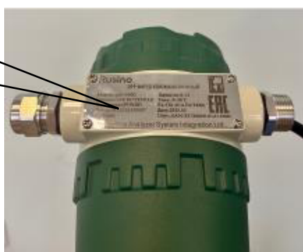
Рисунок 1б – Общий вид задней панели вторичного преобразователя pH-метра с указанием места и формата нанесения заводского номера
