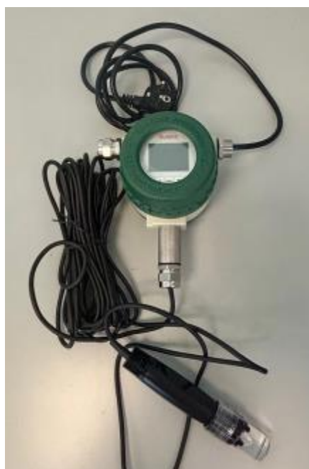
Рисунок 1а – Внешний вид pH-метров промышленных pH-100D
