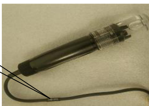
Рисунок 1в – Общий вид датчика pH-метра с указанием места и формата нанесения заводского номера
