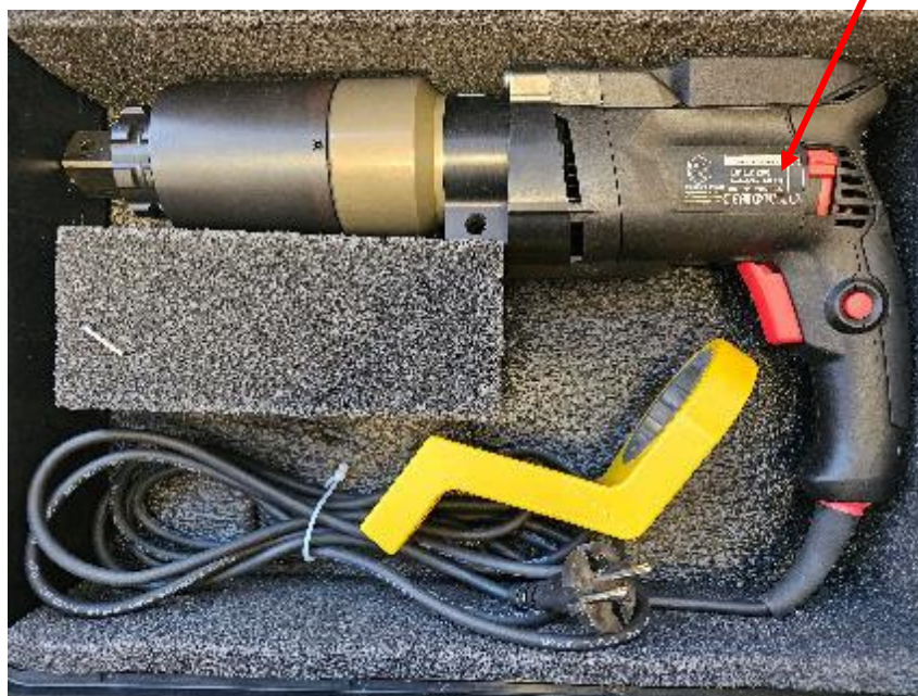
Рисунок 1 – Общий вид гайковертов электрических моментных ЕМЕ (прямое исполнение) с указанием места нанесения идентификационной таблички
