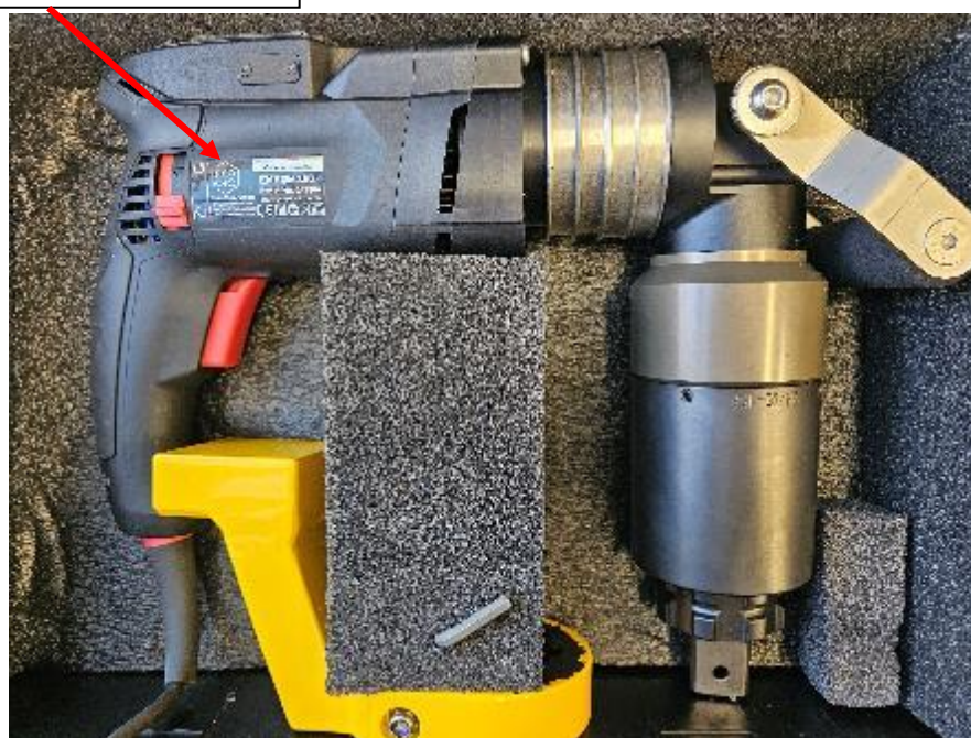
Рисунок 2 – Общий вид гайковертов электрических моментных ЕМЕ (угловое исполнение) с указанием места нанесения идентификационной таблички
