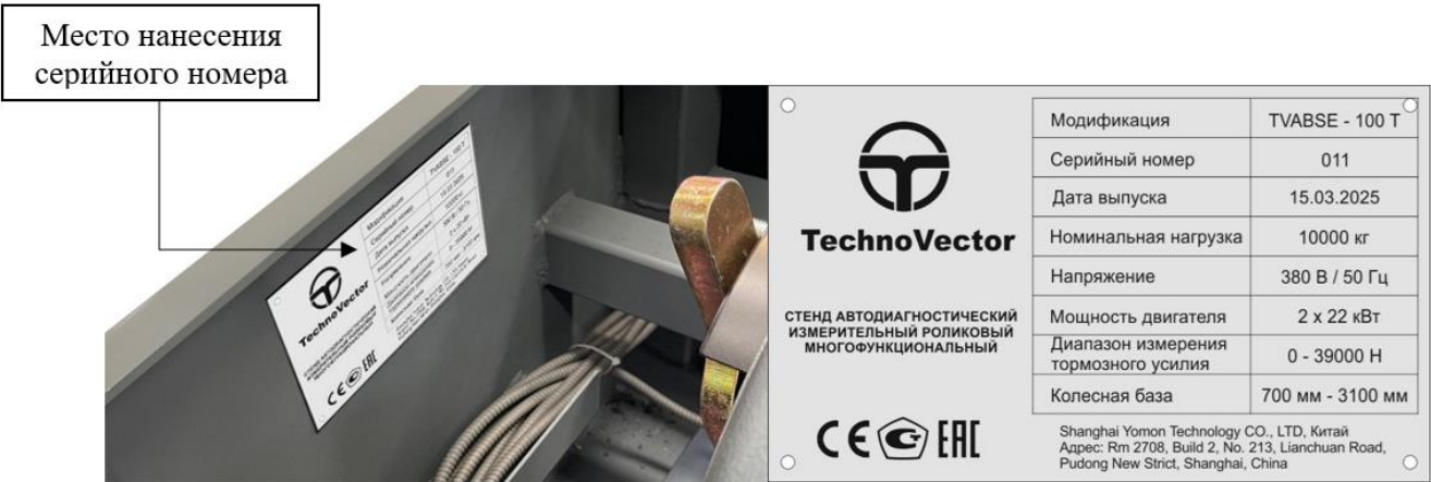
Рисунок 5 – Общий вид маркировочной таблички стандов автодиагностических измерительных роликовых многофункциональных TechnoVector и место нанесения серийного номера
