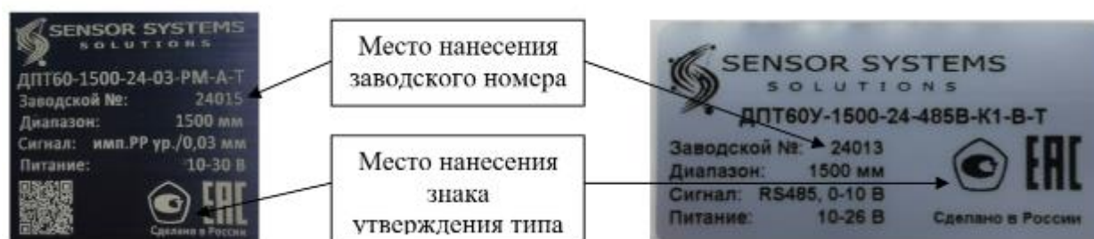
Рисунок 1 – Общий вид идентификационных табличек с указанием места нанесения заводского номера и знака утверждения типа
