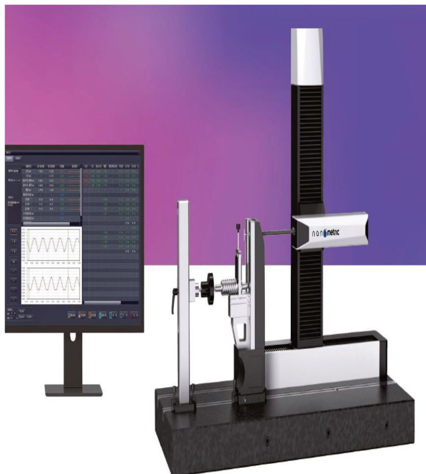
Рисунок 1 – Общий вид приборов с двусторонним сканированием для измерений параметров контура, резьбы и шероховатости поверхности Nanometric ScroM PS582, Nanometric ScroM PS583, Nanometric ScroM PS584
