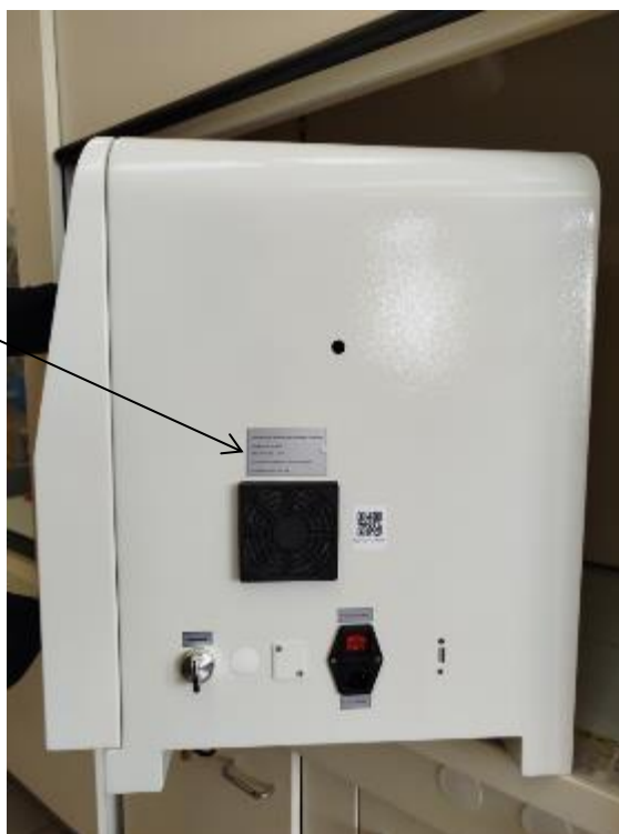
Рисунок 4 – Место нанесения заводского номера
