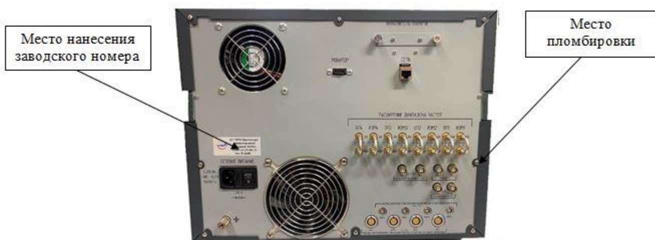
Рисунок 3 – Внешний вид задней панели анализаторов цепей векторных с указанием места пломбировки от несанкционированного доступа и нанесения заводского номера
