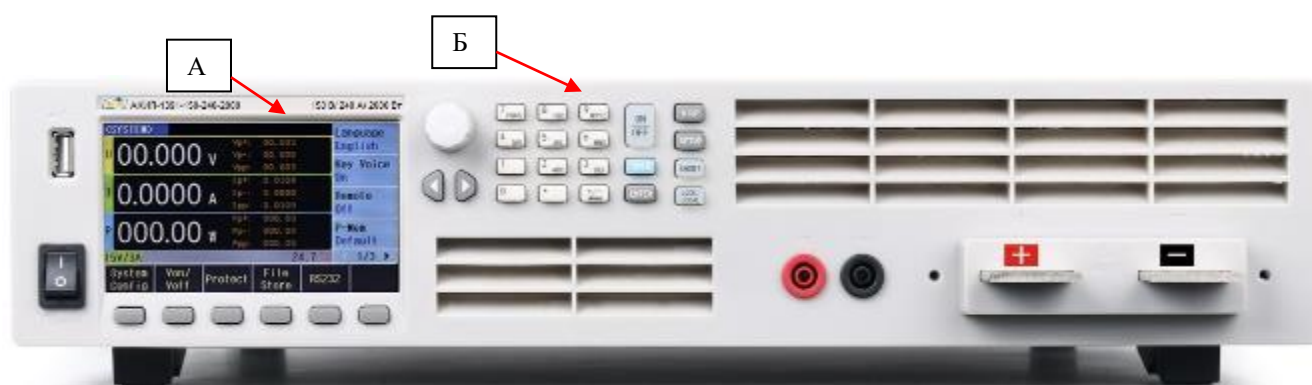
Рисунок 3 – Общий вид нагрузок АКПП-1391-150-120-1000, АКПП-1391-150-180-1500, АКПП-1391-150-240-2000 с местами нанесения знака утверждения типа (А) и знака поверки (Б)
