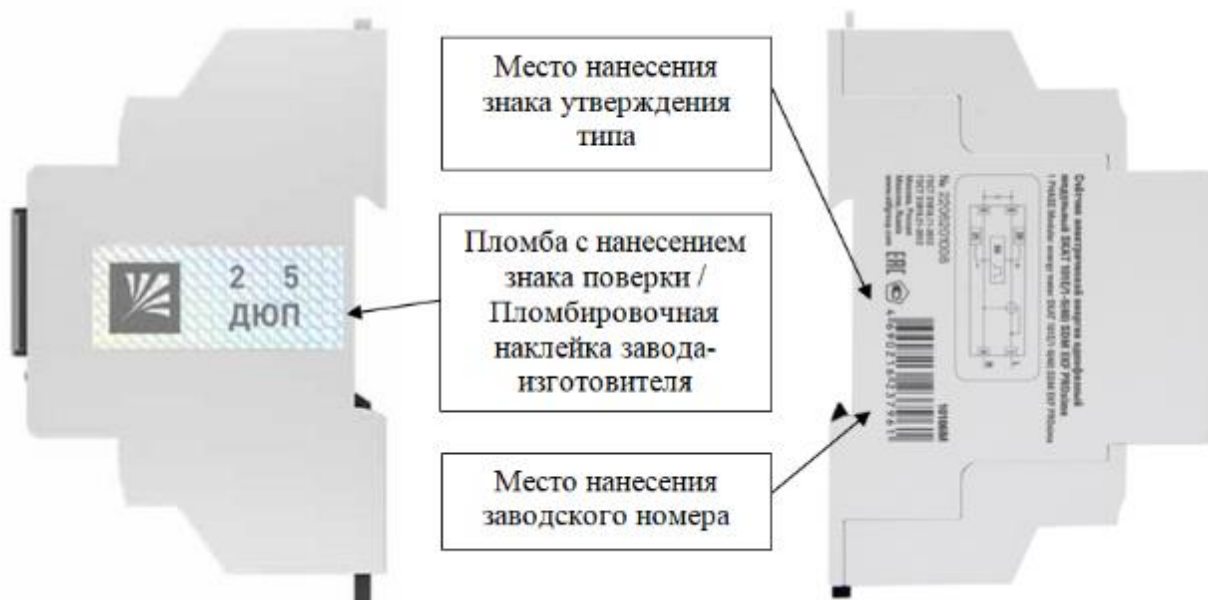
Рисунок 3 – Вид сбоку счётчиков с типом корпуса 101 и креплением D с указанием места ограничения доступа к местам настройки (регулировки), места нанесения знака утверждения типа, места нанесения заводского номера
