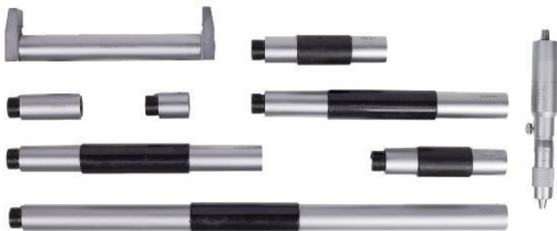
Рисунок 3 – Общий вид нутромеров модели НМ
