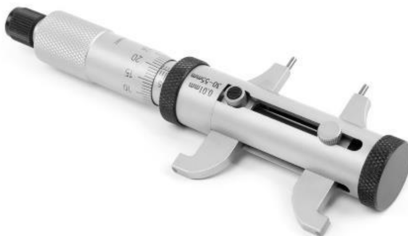
Рисунок 10 – Общий вид нутромеров модели НМ-БД
