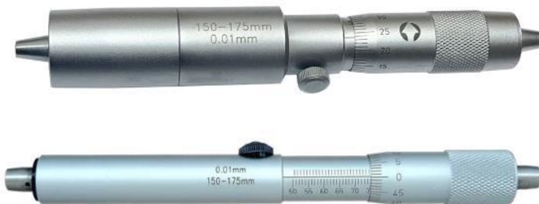
Рисунок 9 – Общий вид нутромеров модели НМ-У
