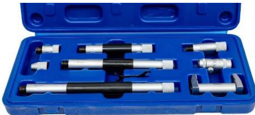
Рисунок 1 – Общий вид нутромеров модели НМ
