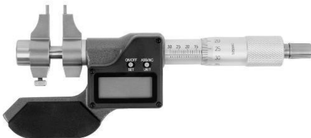
Рисунок 12 – Общий вид нутромеров модели НМЦ-Б
