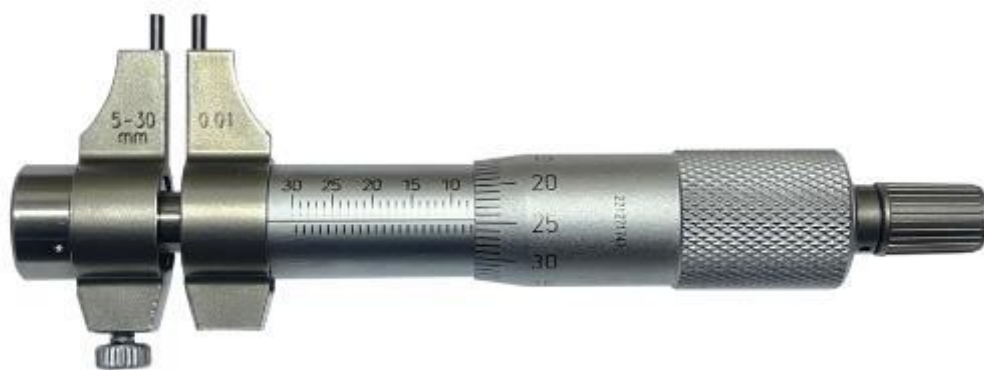
Рисунок 6 – Общий вид нутромеров модели НМ-Б
