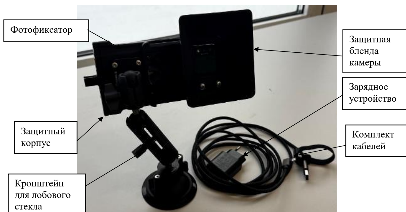
Рисунок 2 – Общий вид составных частей комплексов исполнения СитиСофт-2
