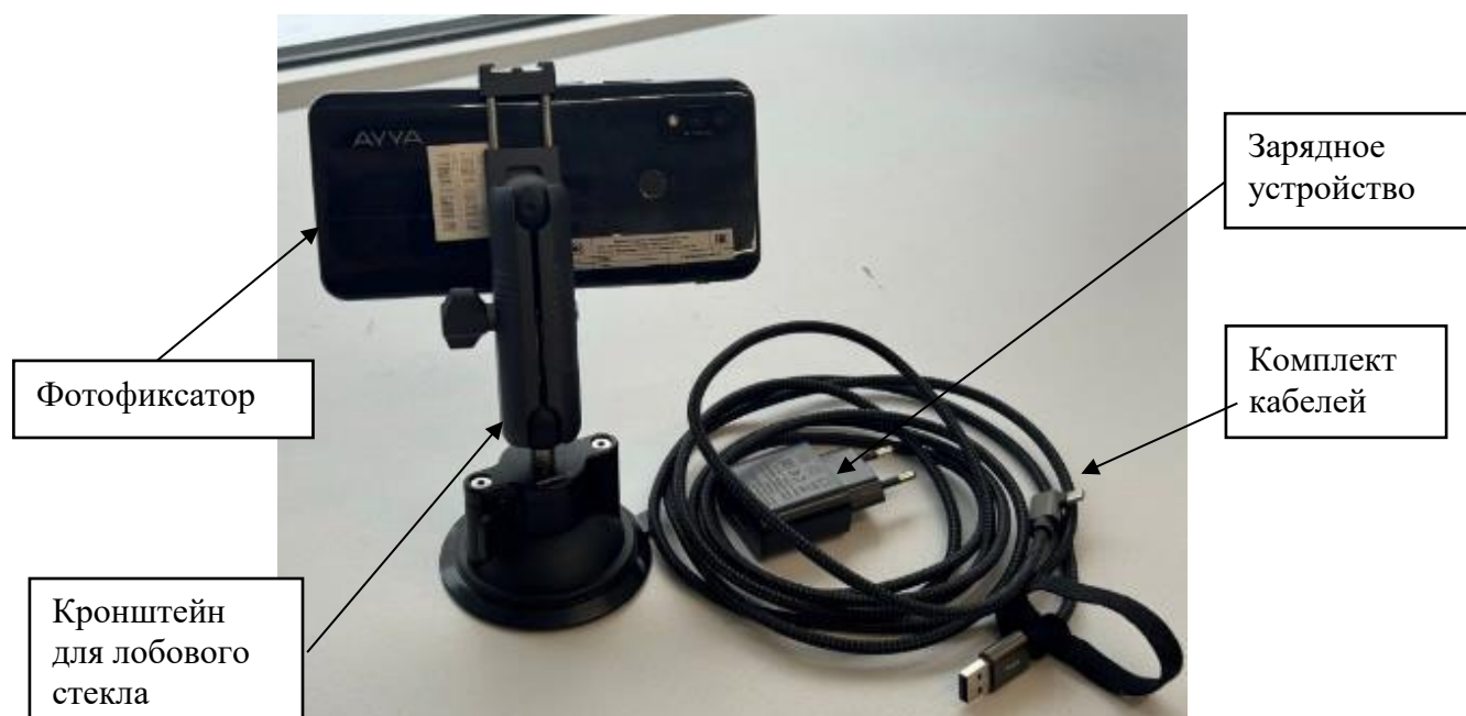
Рисунок 1 – Общий вид составных частей комплексов исполнения СитиСофт-1
