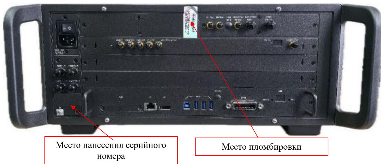
Рисунок 2 – Задняя панель корпуса анализатора спектра и сигналов InfosteraLuna IFL4052 с указанием мест нанесения серийного номера и пломбировки
