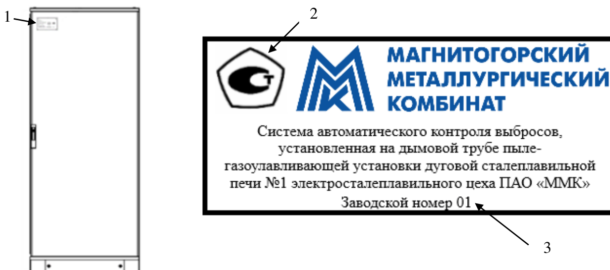
Рисунок 1 – Место нанесения маркировочных табличек (1) на шкафы в составе системы и места нанесения заводского номера (3) и знака утверждения типа (2)
